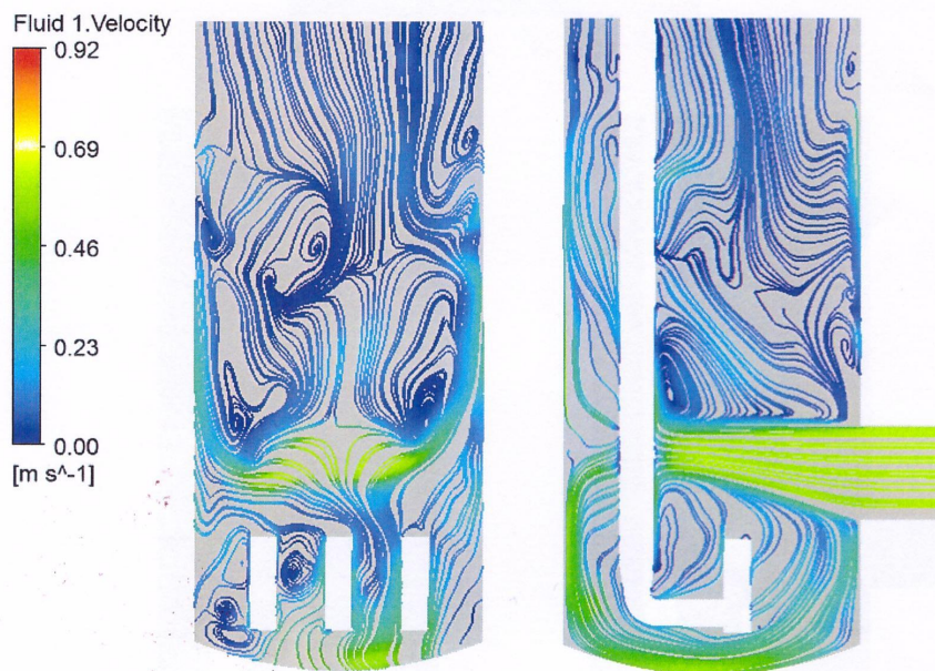
图8 泵组中间截面流线图
